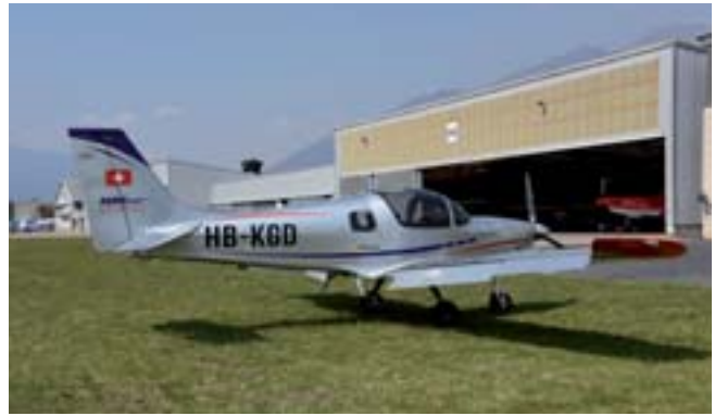
Il Sonaca 200 HB-KGD. L'aereo è completamente in alluminio.
