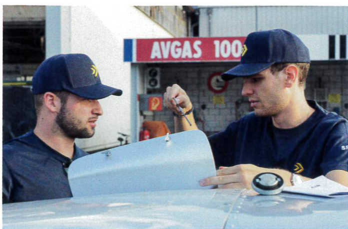
Aircraft Preparation: Die Kontrolle des Ölstands gehört dazu.
